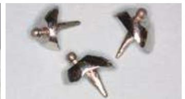
Monofusione: perno cappuccio e sfera fusi. Oltre al parallelismo le sfere sono in posizione sfasata rispetto all'asse del perno
