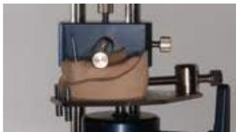
Analisi del modello mediante il Parallelometro Rhein83
