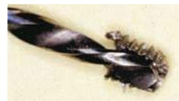
Vite rotta in fase di rimozione
